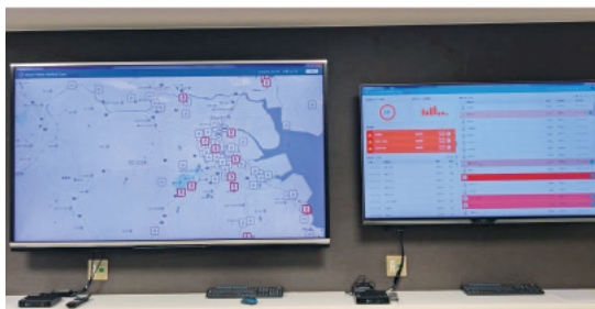
図5 右画面にアラートが点滅し、左画面に患者宅を赤印でマッピングする
